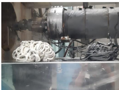
Figura 3. Comparación del material inicial con el que se estaba trabajando la máquina y después de agregar el agente purgante necesario para limpiar el husillo.
