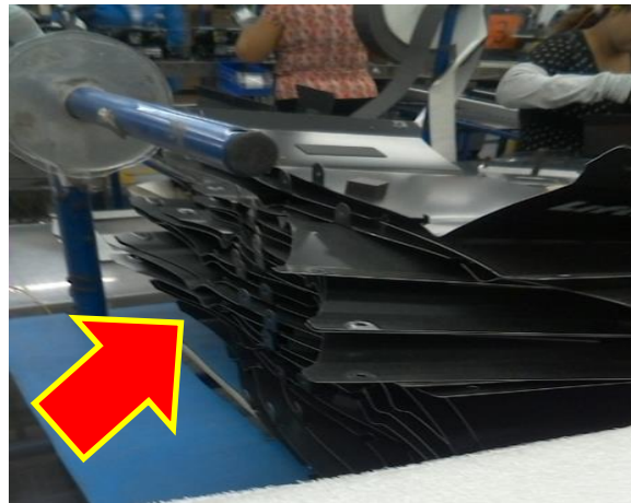
Fig.2 Desperdicio de cubiertas de los abre-puertas inteligentes. (perdida de unidades)
