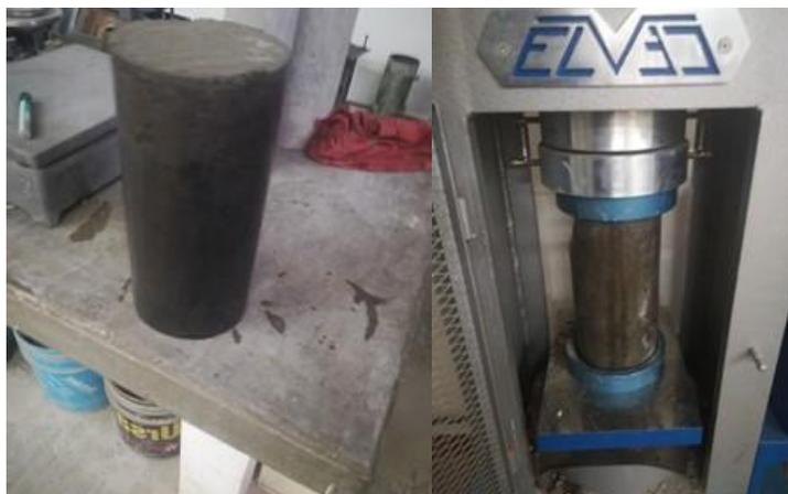
Figura 2. Prueba a la compresión de cilindros.
