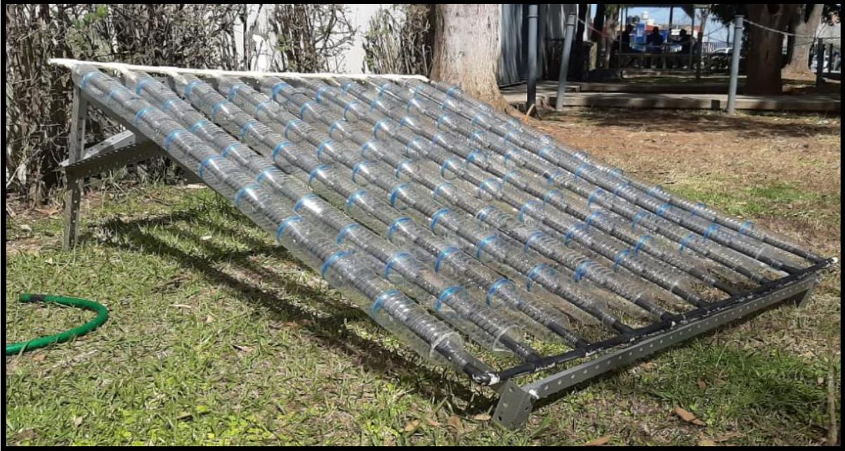
Figura 2. Colector solar plano.
