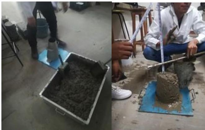
Figura 2. Prueba de revenimiento del concreto.
