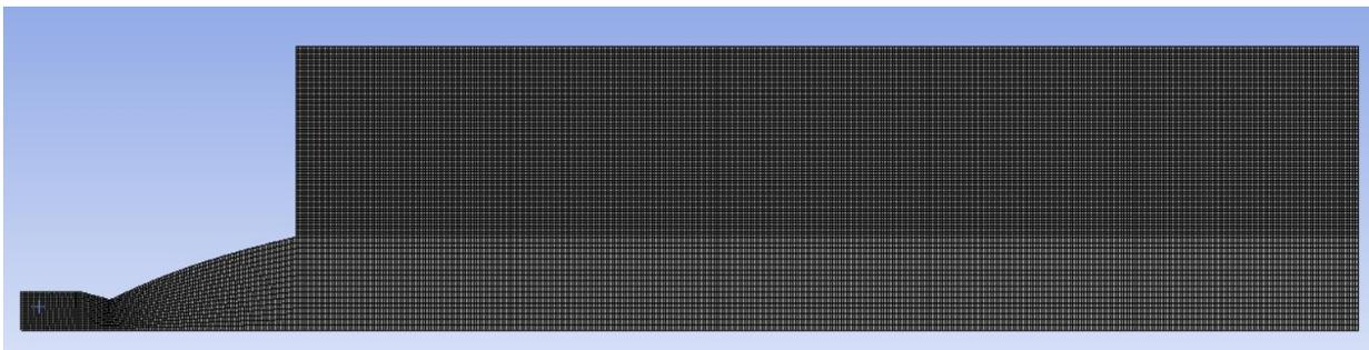
Figura 1 Mallado estructurado.
