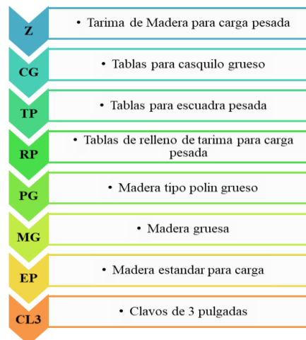
Imagen 2. Codificación de componentes de una tarima para carga pesada. Fuente: Elaboración propia
