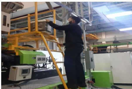
Figura 1. Operación que realiza el técnico de inyección para subir el agente purgante a la tolva de alimentación.
