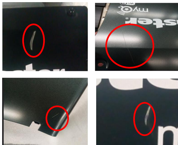
Fig.1 Defectos cosméticos en las cubiertas de los abre-puertas inteligentes (rayones)
