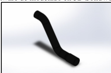
Figura 1. Modelo matemático de la manguera inferior de un radiador.
