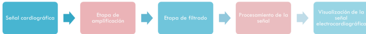
Figura 1. Diagrama de bloques. Estructura del electrocardiograma para la adquisición de la señal.
