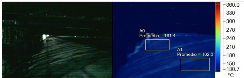
Figura 6. Termografía realizada a bóveda tradicional, vista 1.
