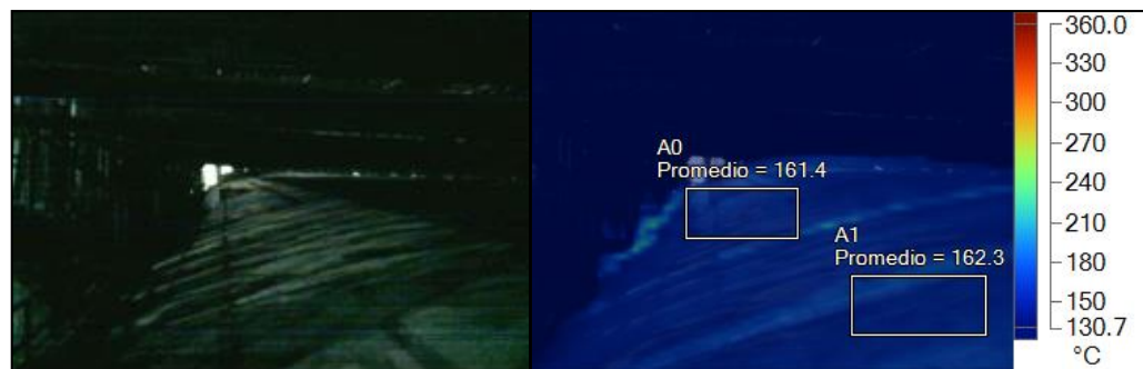
Figura 6. Termografía realizada a bóveda tradicional, vista 1.
