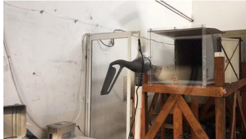
Figura 7. Aerogenerador en funcionamiento con velocidad controlada.
