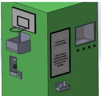
**Figura 1. Modelo de 3D de la máquina de reciclaje propuesta.**
