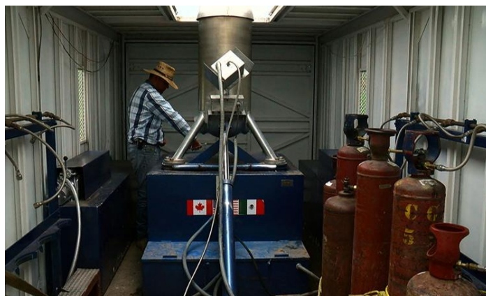
Fig.3 Utilización de gas acetileno para disparar en las nubes. Fuente; UnoTV
