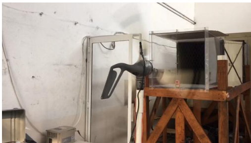
Figura 7. Aerogenerador en funcionamiento con velocidad controlada.
