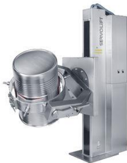
Fig. 1: Mezclador de tambor o volteo
