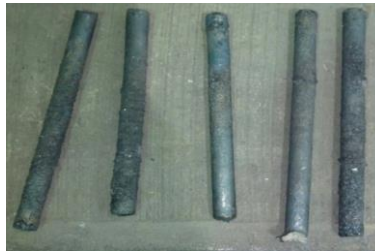
Figura 1. Geometría de las barras obtenidas en el proceso de fusión y moldeo en verde.
