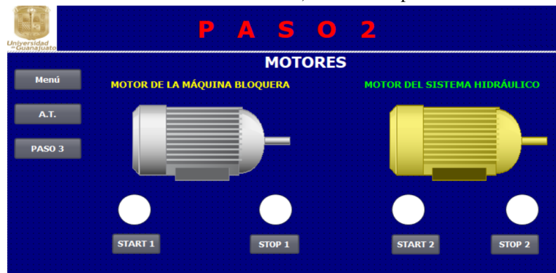
c) Paso 2. Encendido y apagado de los motores.
