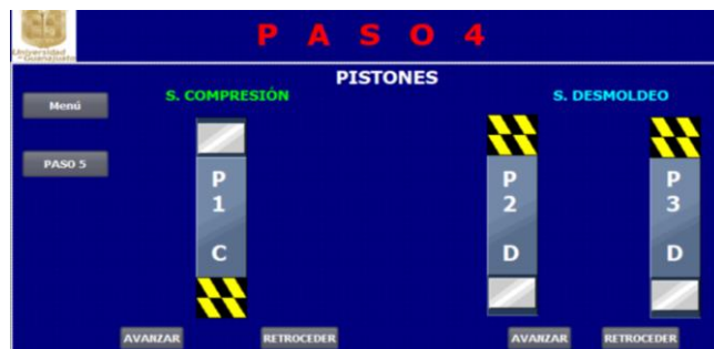
e) Paso 4. Control de los pistones.
