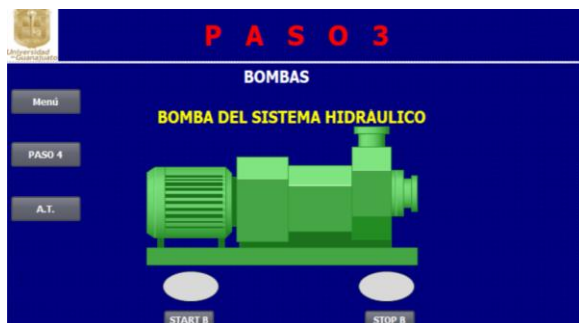
d) Paso 3. Encendido y apagado de la bomba.
