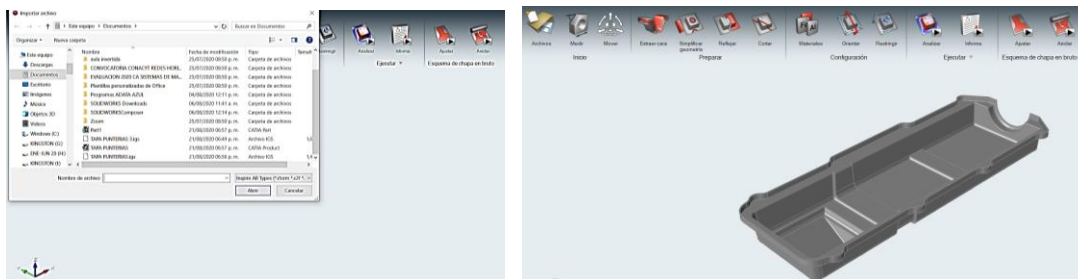
Figura 9. Importar un modelo CAD. Seleccionar el archivo en directorio IGES, STEP o x_t y generación de la geometría de análisis en el software.
