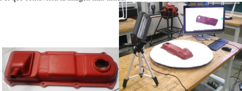
Figura 2. Tapa de puntería pintada para escaneo.
