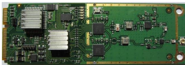
Figura 5. Módulo LoRa mPCIe LG9271 de Microchip/Occammd.
