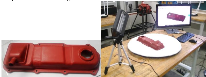
Figura 2. Tapa de puntería pintada para escaneo.
