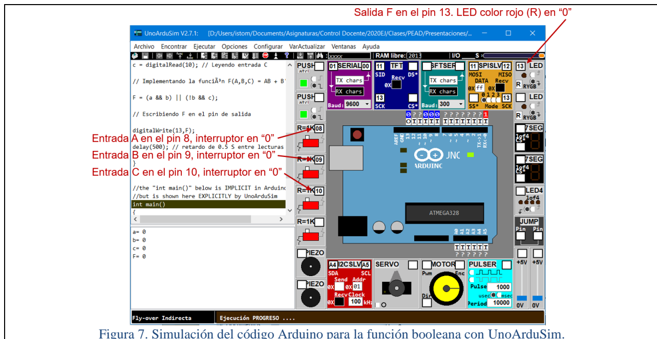
Figura 7. Simulación del código Arduino para la función booleana con UnoArduSim.
