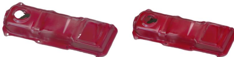
Figura 3. Captura de la pieza como superficie y como sólido.
