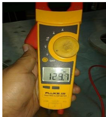
Figura 10. Lectura de la prueba de tensión de alimentación.
