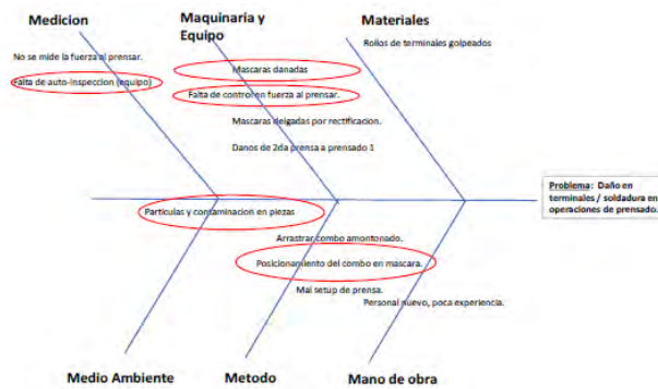
Figura 8. Diagrama Ishikawa X1 Daño de terminales/soldadura en operaciones de prensado, Matriz Causa y Efecto y 5 porqués. Se realizó la misma secuencia para X2, X3 y X4.
