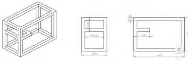
Figura 3. Estructura de la máquina (medidas en mm)
