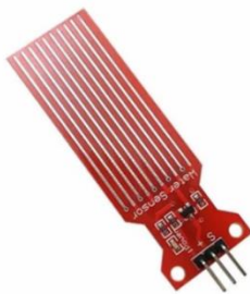
Fig 5 Sensor de lluvia
