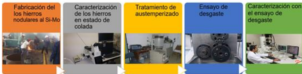
Figura 3.- Metodología experimental realizada en la fabricación y caracterización de los hierros nodulares
