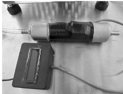
Figura 6. Nariz electrónica en su tubo de paso de Biogás.
