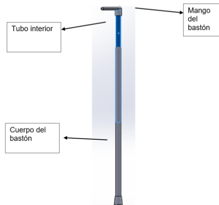
Figura 7. Ensamble mango de bastón con el tubo interior.
