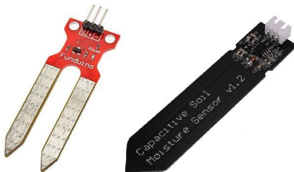
Figura 2. Sensores de humedad del suelo. Resistivo y capacitivo.
