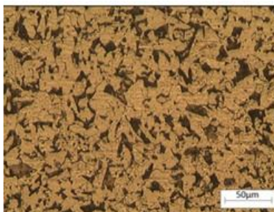
Figura 4. Microestructura presente en la probeta testigo, a 10X.
