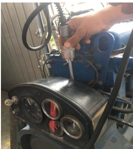
Figura 4. Punto de medición de la vibración en posición vertical
