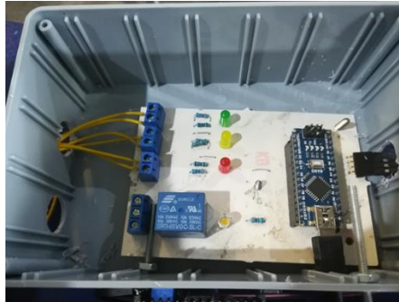
Fig.16.- Placa electrónica con salida analógica y digital
