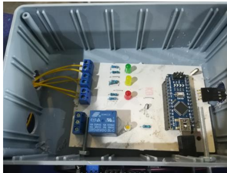
Fig.16.- Placa electrónica con salida analógica y digital
